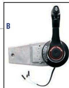
**REMARQUE :** Nous recommandons les câbles PRO-X Cables<sup>MC</sup> de Glendinning. Toutes les commandes fonctionnent avec des câbles universels 3300/33C. Reportez-vous au *Guide de gréement* pour les spécifications.
